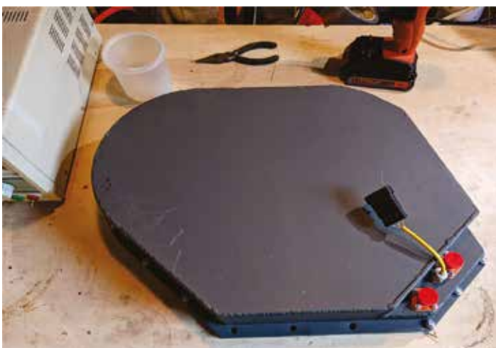
Widok kompletnej gotowej baterii trakcyjnej, której wodoodporną obudowę wykonano z grubej blachy aluminiowej
