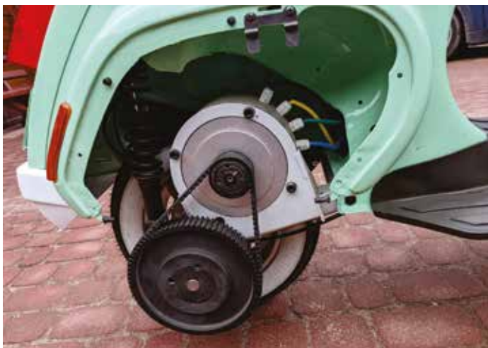
Widok kompletnego napędu elektrycznego koła skutera zamontowanego na nowym wahaczu, składającego się z silnika BLDC i przekładni napędowej z paskiem i kołem zębatym wykorzystanymi z napędu rozrządu starego samochodowego silnika spalinowego
