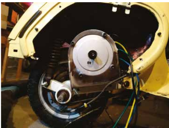
Widok nowego wahacza z zamocowanym nań elektrycznym silnikiem BLDC
