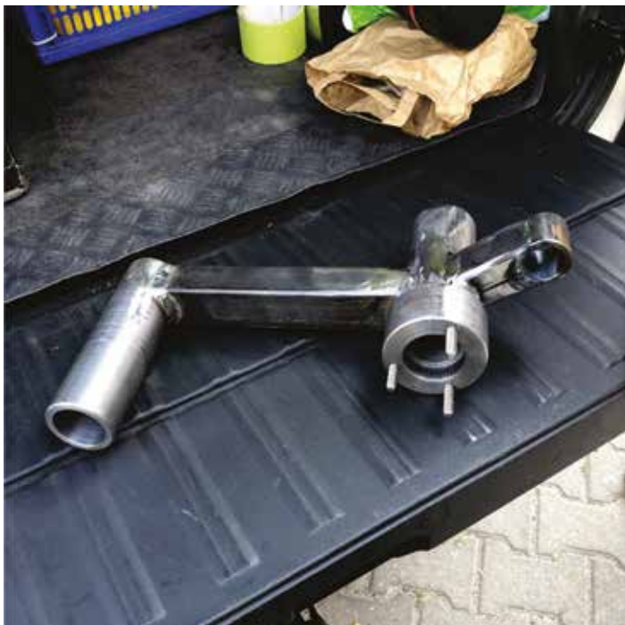
Nowy wahacz wykonany na zamówienia wg własnego projektu
