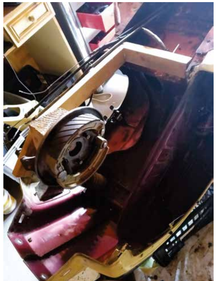
Weryfikacja projektu konstrukcji mechanicznych z wykorzystaniem przestrzennych modeli drewnianych
