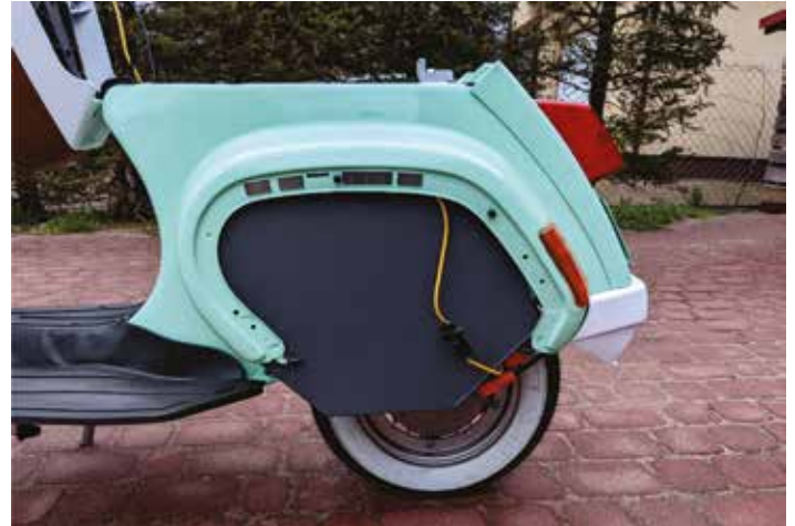
Sposób zamocowania baterii trakcyjnej w skuterze
